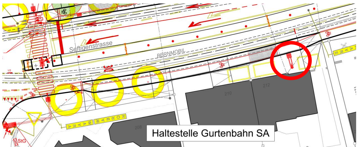
Abbildung 14: Haltestelle Gurtenbahn stadtauswärts, Blinderquadrat versetzt
