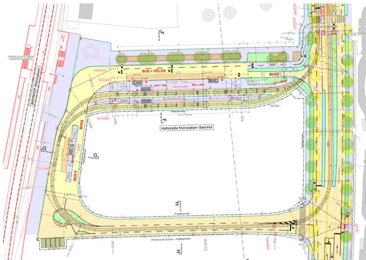
Abbildung 11: Bereich Wendeschleufe, Kleinwaben Bahnhof, Planausschnitt aus Situationsplan
