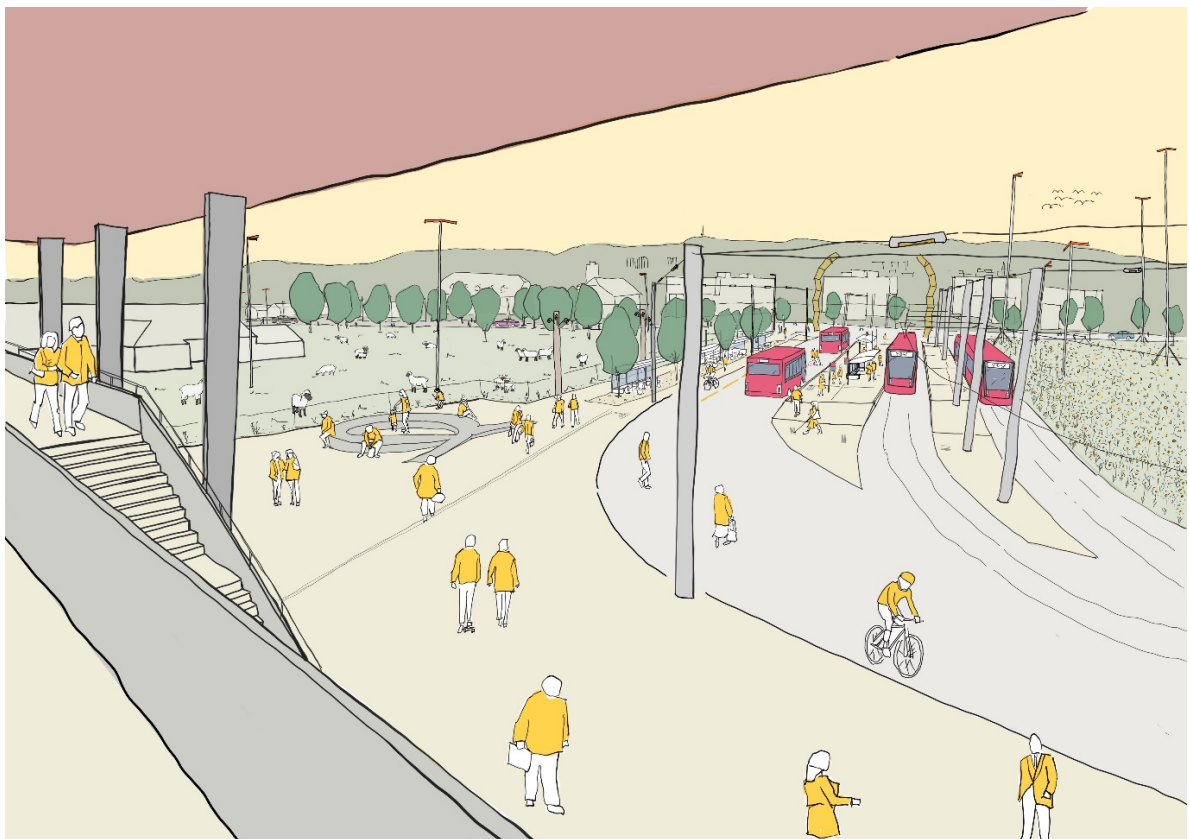
Abbildung 13: Visualisierung Dank übersichtlicher Anordnung, platzsparender Organisation, einfachen Materialien sowie gestalterischen Interventionen zur Möblierung und ökologischem Ausgleich integriert sich die Endhaltestelle und Umsteigeanlage in die heutige Situation ebenso wie bei einer künftigen baulichen Entwicklung seines Umfeldes
