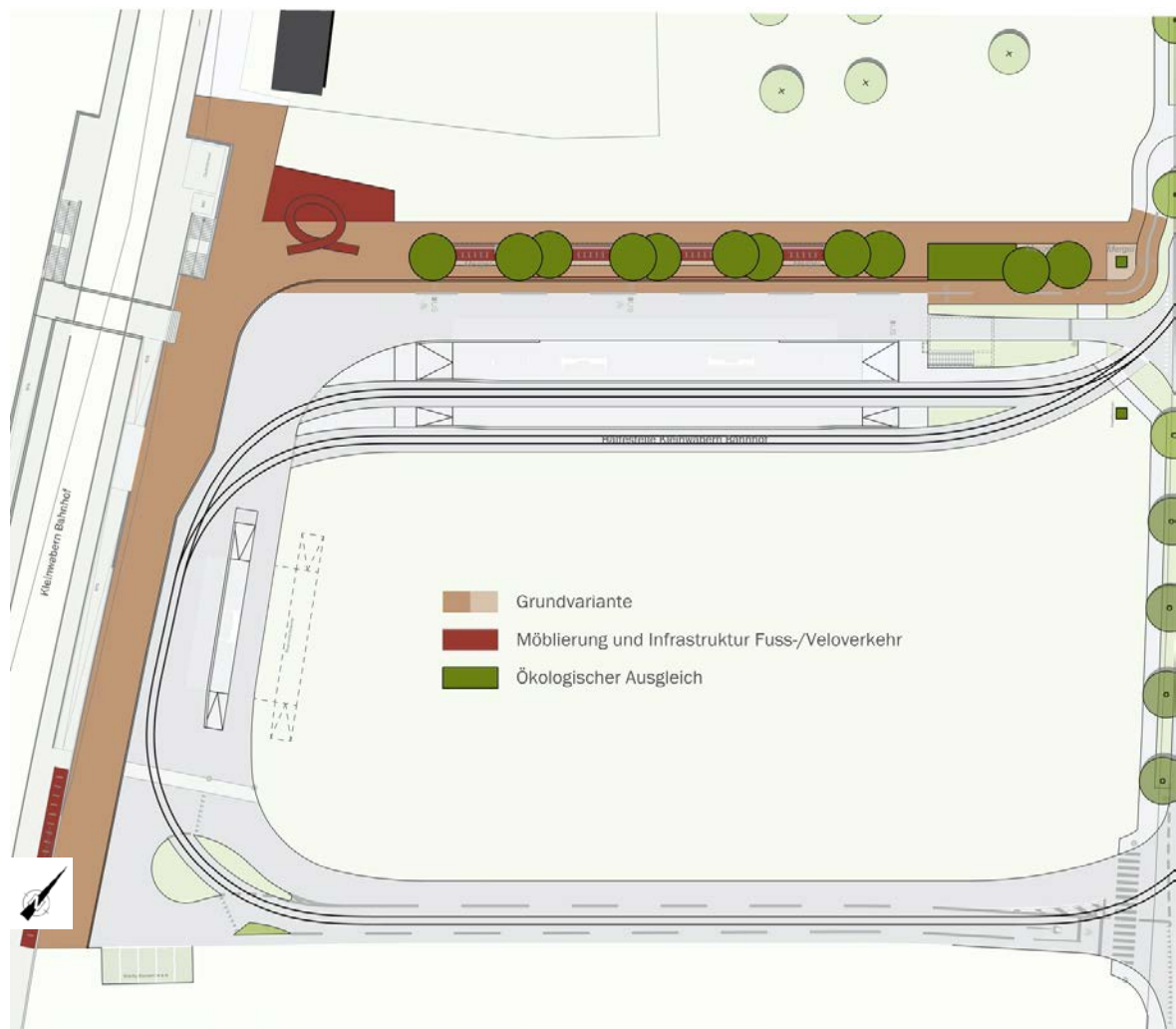
Abbildung 14: Grundausrüstung der Endhaltestelle und Umsteiganlage und Flächen für Möblierung und ökologischen Ausgleich
